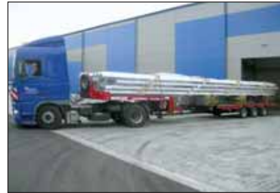
Výroba a doprava trapézových plechů délky až 22m
